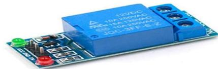
Fig8. Relay module
